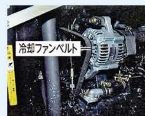
冷却ファンベルトは張り・摩耗・亀裂を確認します。たわみ量（張り具合）の基準は15~20mmです。（調整、交換は個々の取扱説明書を参照）
